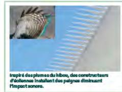
Inspiré des plumes du hibou, des constructeurs d'éoliennes imitent les péages diminuant l'impact sonore.
