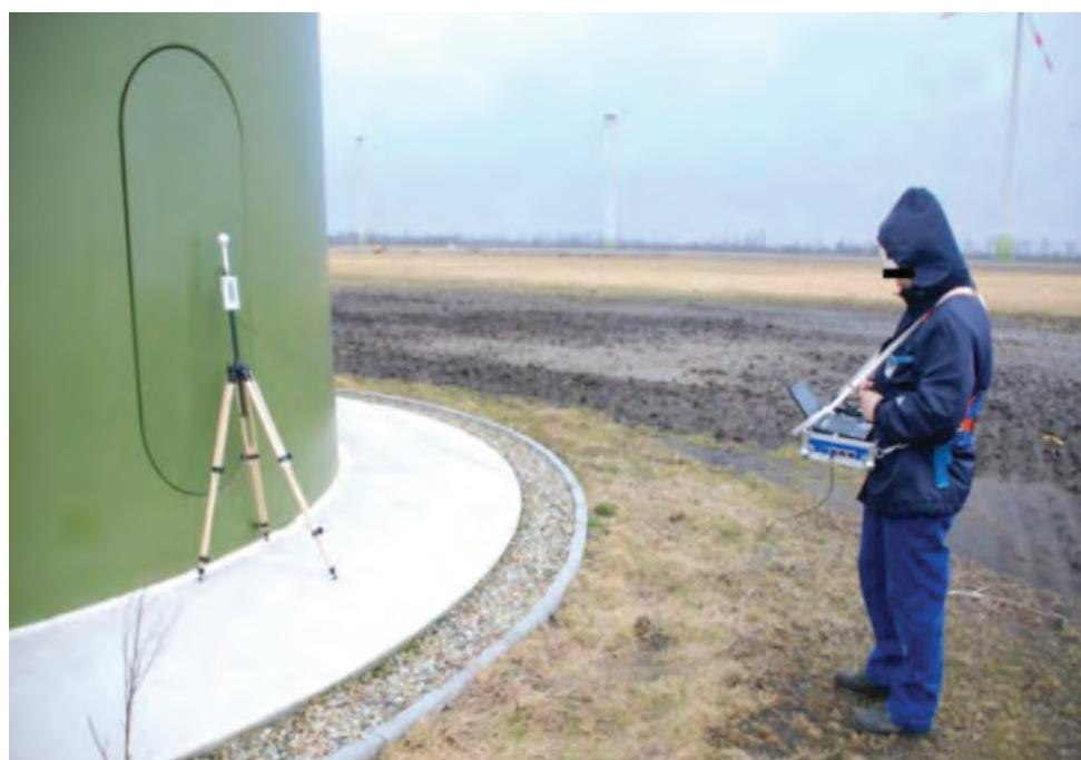
***Mesure du champ magnétique sur une éolienne ENERCON***
